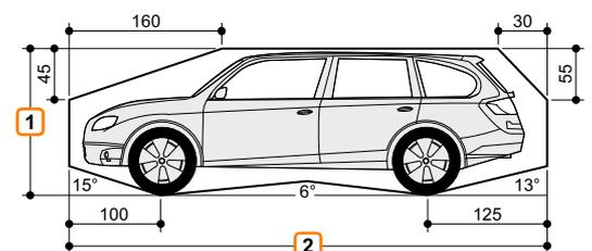
Ширина автомобиля 190 см при ширине платформы 230 см. Соответственно более широкие автомобили возможно парковать на более широких платформах.
